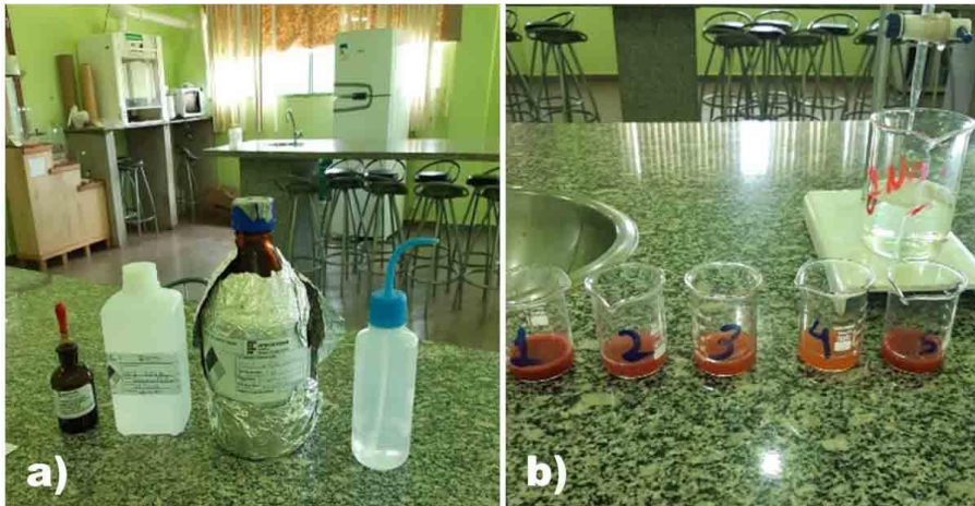
Figura 6 - Determinação do cloreto na água dos bebedouros do IFRO – campus Colorado do Oeste. (a) Reagentes utilizados pelo Método de Mohr. (b) Realização da análise.
