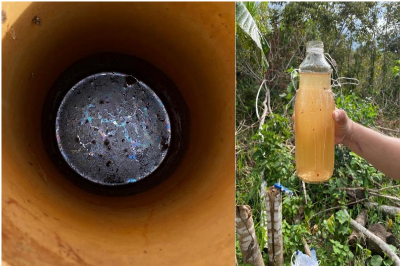
Figura 8. Detecção visual da presença de óleo ou graxas na superfície das amostras coletadas
