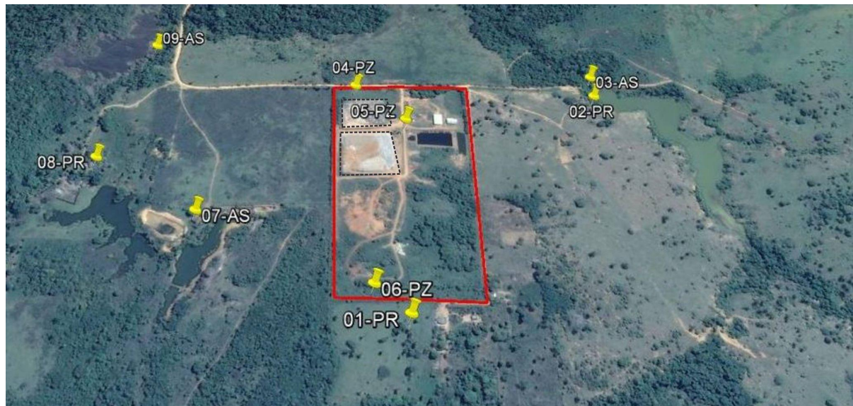
Figura 1 – Localização e coordenadas geográficas dos pontos de coleta de dados no aterro sanitário do Município de Ariquemes-RO, 2015. Área do aterro (linha sólida), célula de depósito de RSU (linha pontilhada). PR: Poço Raso. PZ: Piezômetro. As: Água Superficial.
